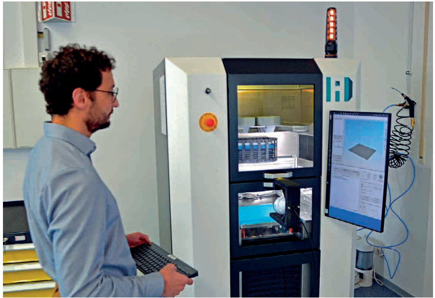
Sebastian Kallenberg, ingeniero de proyecto en Naddcon, durante el control de la instalación CEM. Foto: Aim3D GmbH.
