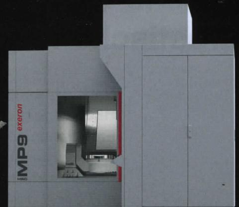
In der neuen linear angetriebenen HSC MP9 hat exeron seine langjährige Erfahrung konsequent mit Kundenanforderungen vereint. So entstand ein fünffachsiges Hochgeschwindigkeitsfräszentrum, das mit Spindeldrehzahlen von 42.000 U/min und einem Arbeitsbereich von 650 x 625 x 400 Millimeter Werkstücke mit bis zu 250 kg bearbeiten kann – kurz gesagt: Die kleine Große für mehr Produktivität und Präzision [www.exeron.de](http://www.exeron.de)
