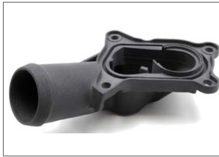
Kühlmittelverteilerstutzen von Schaeffler aus PPS GF 40 Type Fortron 1140L4 von Celanese, hergestellt im Granulat-3D-Druck (Bild: Schaeffler)
