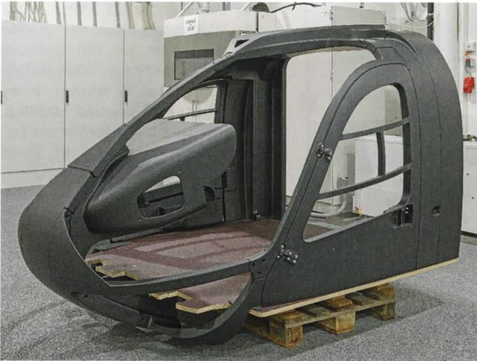
Anwendungsbeispiel des grossvolumigen 3D-Drucks: Helikopter-Cockpit-Conversion Kit als modularer Aufbau mit hoher Oberflächengüte und hoher Masshaltigkeit – sehr gross und spaltmassoptimiert.
