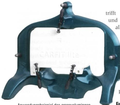
Anwendungsbeispiel des grossvolumigen 3D-Drucks: Messaufnahme Automotive präzise und masshaltig.
