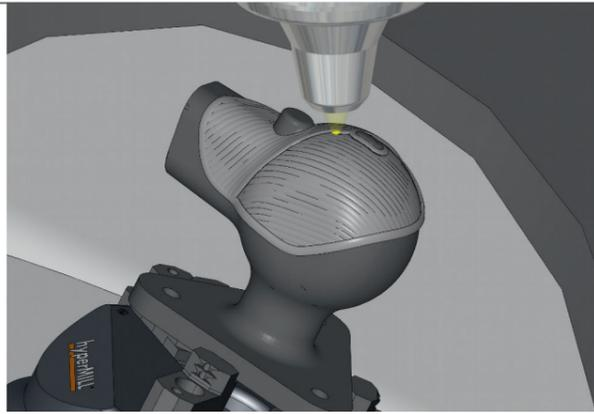
**Auftgetragen:** Die additive Fertigung eines bestehenden Rohlings für die Medizintechnik erfolgt in verfahrensgerechten Bewegungen
