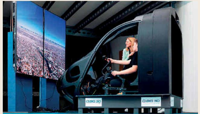
Das Cockpit-Conversion Kit überzeugt als modularer Aufbau mit hoher Oberflächengüte und Maßhaltigkeit; auch die Spaltmaße an der vollständig funktionsfähigen Türe wurden eingehalten. Foto: Q.Big 3D
