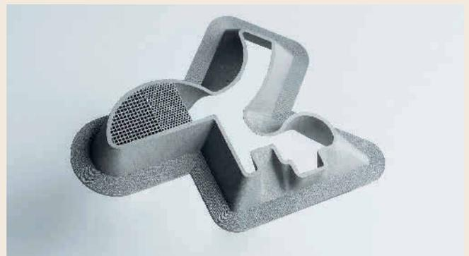
Additiv gefertigtes Musterbauteil aus Wolfram mit unterschiedlichen Oberflächenorientierungen und integrierten Gitterstrukturen. Foto: Plansee
