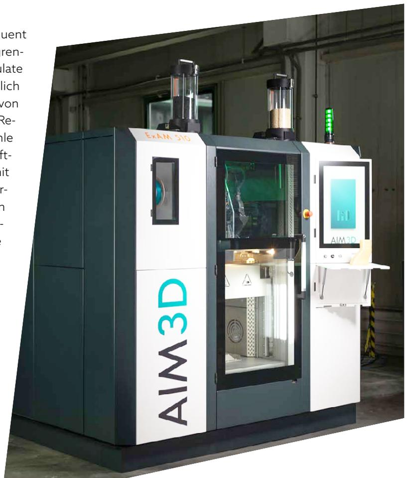
Der Drucker ExAM 510 mit einer maximalen Baurate von derzeit 150 cm<sup>3</sup>/h.
