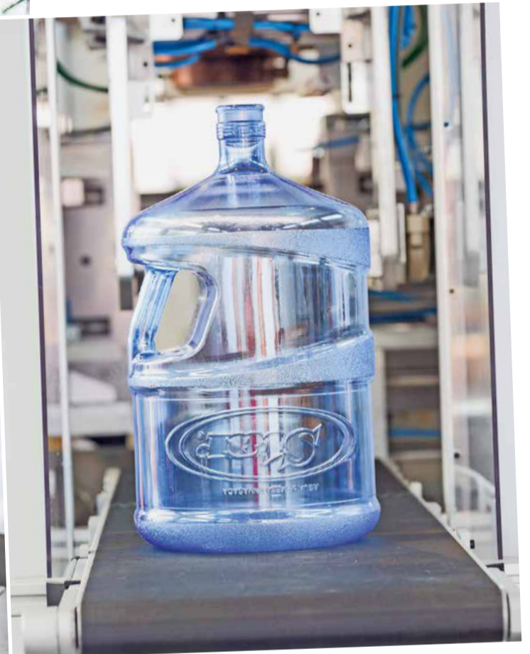
Kompakt und leistungsstark: Bekum BA 25 Hochleistungs-Blasformmaschine für die 5-Gallonen-PC-Wasserflaschenproduktion Foto: Bekum
