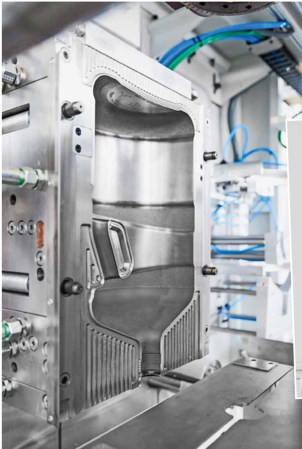
Blick in die geöffnete Blasform mit Mehrzonentemperierung zur Herstellung eines Wasserflaschenbehälters aus PC Foto: Bekum
